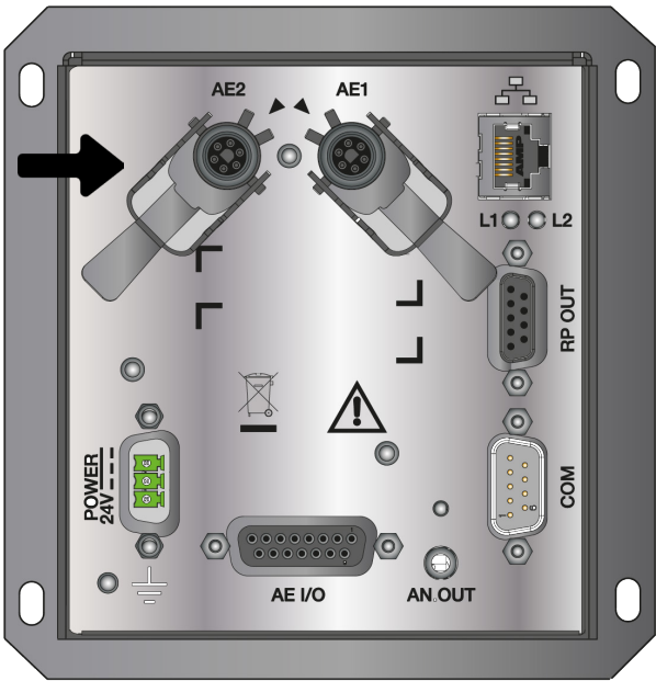
Prolongación para sensor acústico
